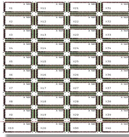
Le schéma comprend 40 sous-schémas identiques et 2047 résistances dans chaque sous-schéma en topologie cellulaire (le nombre de branches est de 81880).
